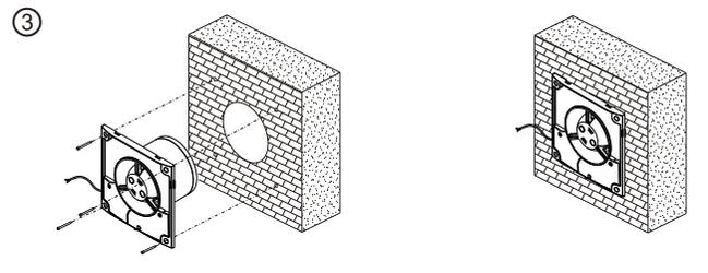
Introducir el cuerpo del extractor en el agujero de la pared y fijar los 4 tornillos que se incluyen con el producto.
